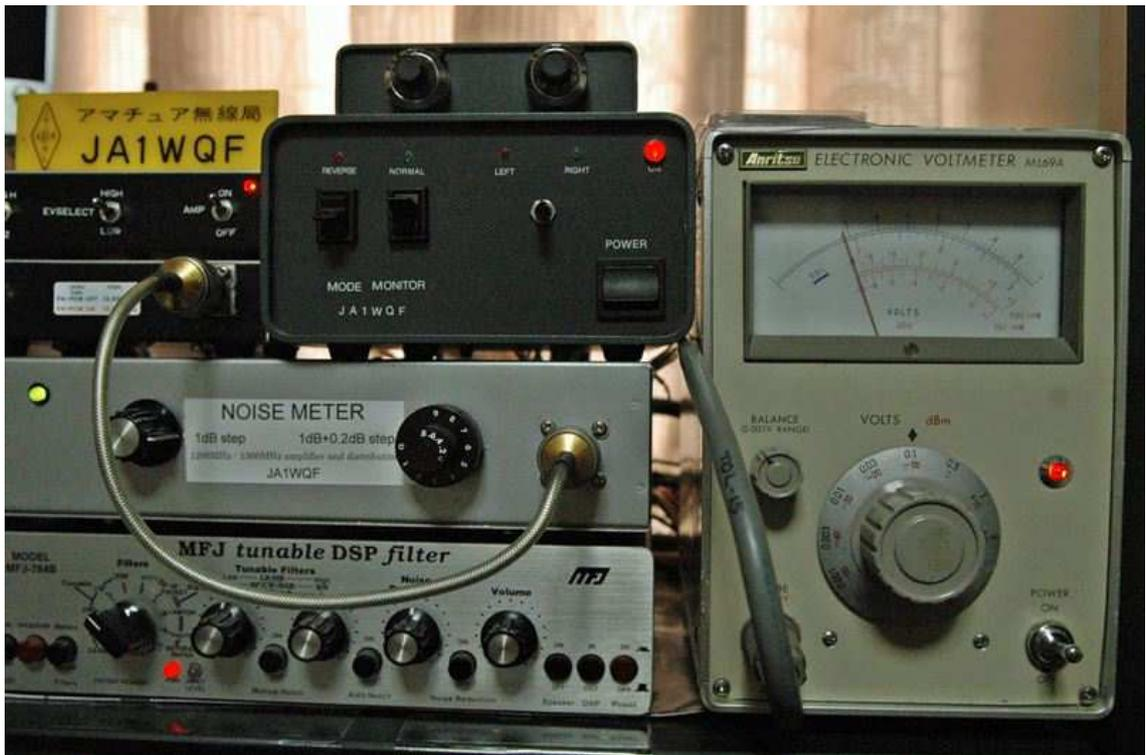
C) サンノイズのピークを取ってすぐに ATT を調整し、先ほど設定のゼロ点に合わせる。
