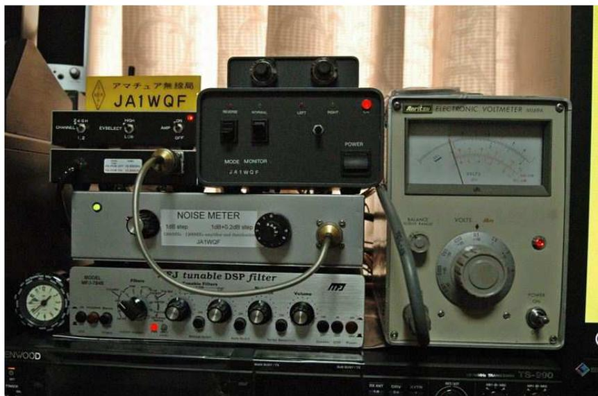
B) ロータリーATT でゼロ点に合わせる (この基準点は何処でも OK) 私の使用 ATT は 1dB ステップと 1dB ステップ+0.2db ステップ直列で 0~19.8dB の値です (通常は 20dB あれば大丈夫です)
