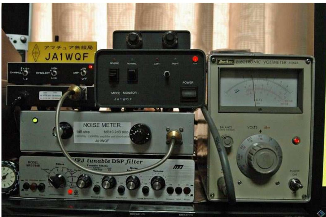
私の例ですが、IF の 1200MHz を「Noise meter」の Box 内で 2 分配しトランスバーターとメーターに分け送受自動切り替え、ロータリーATT を介し IF アンプ (メーターアンプ) で増幅後アンリツ ML69A にて計測しています。
